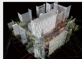
[도심지 현장 주변 시설물 현황 스캔(+BIM)]
